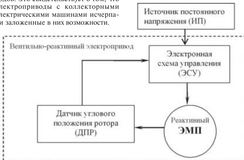
Рис. 1. Структурная схема вентильно-реактивного электропривода
