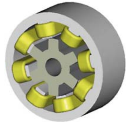
Рис. 2. Реактивный ЭМП ВРЭП с соотношением числа полюсов статор/ротор – 8/6
