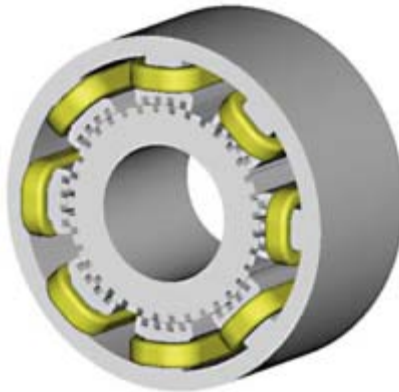
Рис. 4. Высокомоментный низкоскоростной реактивный ЭМП ВРЭП
